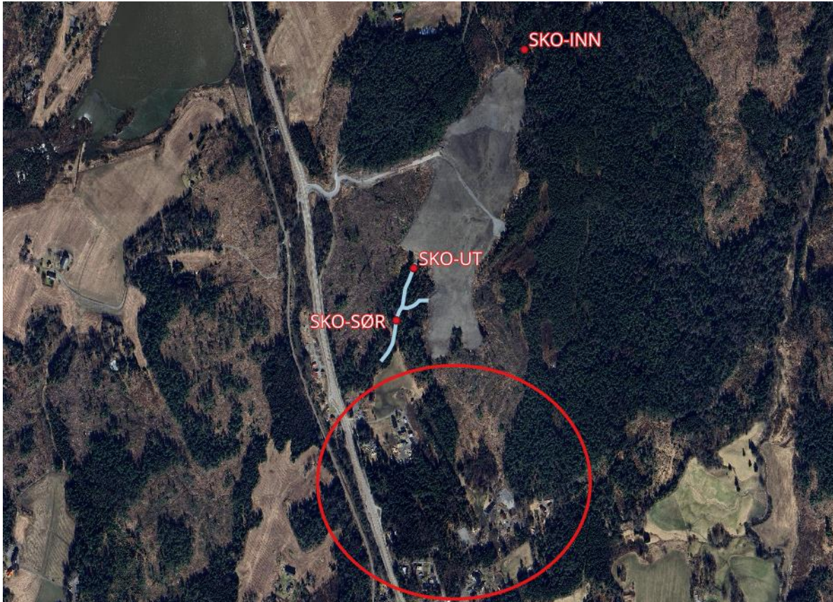
Figur 3-1. Plassering av prøvepunkter ved Vestby skogsdeponi. Overvåkningspunkter for bekkevann er vist med røde punkter. Område for de tre prøvetatte drikkevannbrønnene sør for fyllingen er vist med rød sirkel. Blå streker viser til bekkeløp.
