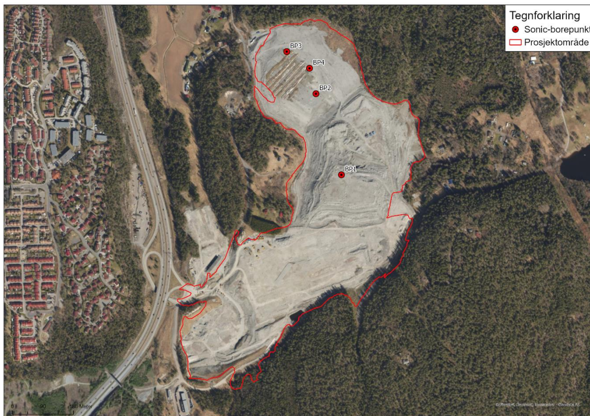
Figur 1. Oversiktskart over anleggsområdet på Åsland med plassering av borpunktene (BP1-BP4) tegnet inn. Rød linje markerer utstrekning av tilbakeføringsområdet.
